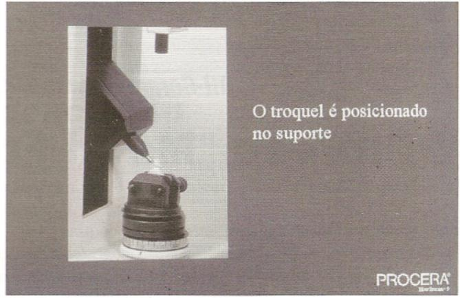
Fig. 2 - Escaner do sistema Procera.
