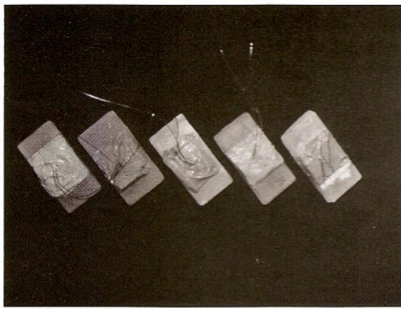
Fig. 6 - Amostras após o teste de tração.
