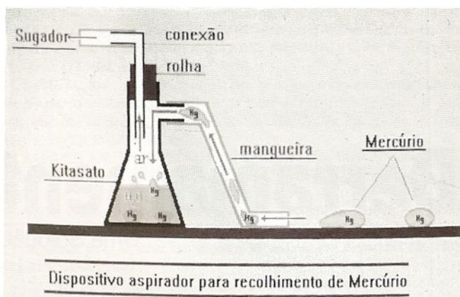
Fig. 2 - Esquema do funcionamento do dispositivo coletor de mercúrio.
