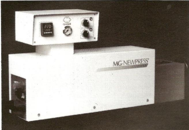
Fig. 7 - Equipamento que realiza a termoplastificação e injeção da resina acetal na mufla.
