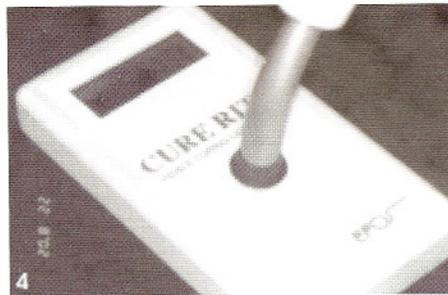
Fig. 4: Radiômetro Cure Rite (Efoss) utilizado para determinar a intensidade de radiação eletromagnética sobre uma definida faixa de comprimento de onda.
