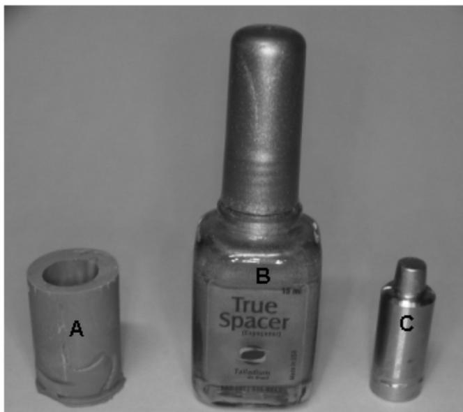
Figura 1. A) Molde de silicona; B) Espaçador para troquel; C) Troquel metálico.
