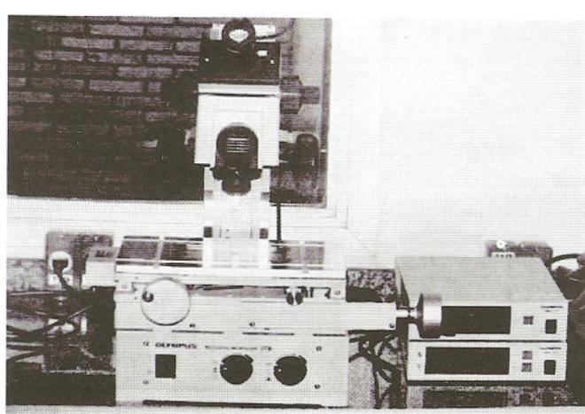
Fig. 3 - Microscópio Comparador - FOP - UNICAMP.
