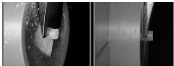
Figura 3. Vistas laterais em que a lâmina está posicionada na interface esmalte/restauração exercem compressão sobre o espécime.
