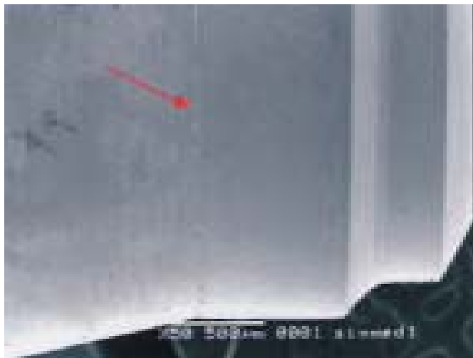
Fig. 5 - Sistema implante-abutment e micro fenda formada (seta) (50 X).
