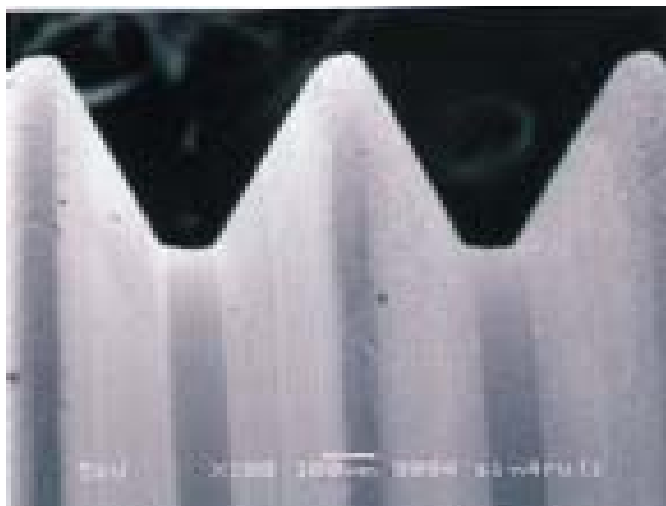
Fig. 1 - Limite entre a porção rugosa e a porção lisa do implante (100 X).
